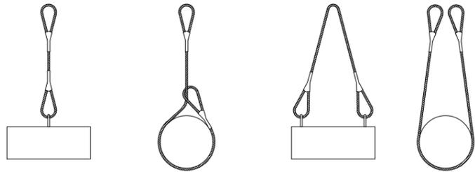
NUNCA SE DEBEN CRUZAR LAS ESLINGAS. SI SE MONTA UNA SOBRE OTRA, PUEDE PRODUCIRSE LA ROTURA DE LA ESLINGA QUE QUEDA APRISIONADA.
