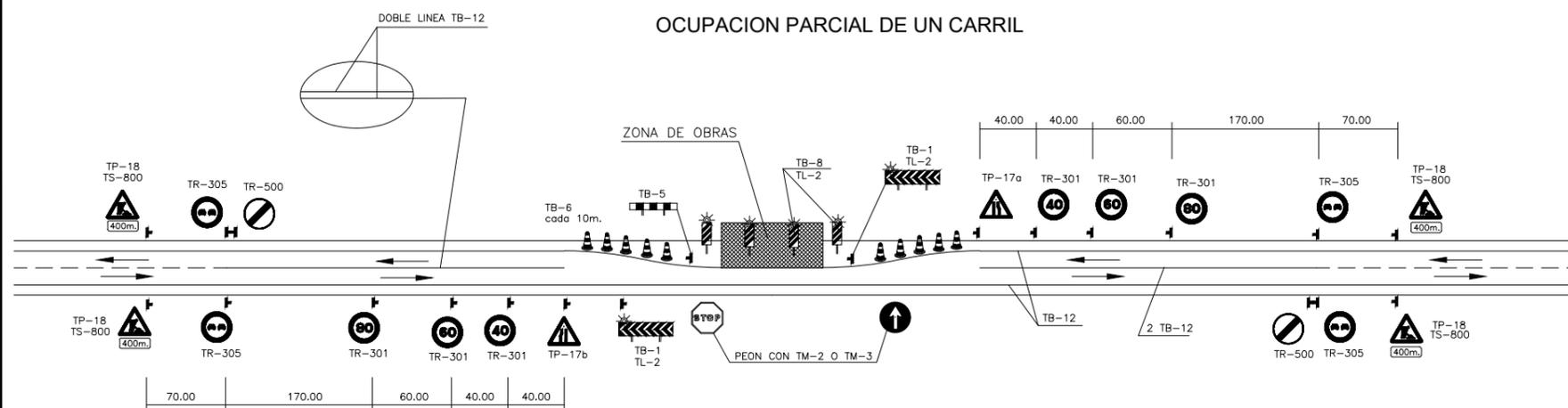
DIMENSIONES MINIMAS EN cm. DE LOS ELEMENTOS DE SEÑALIZACION Y BALIZAMIENTO DE OBRAS
