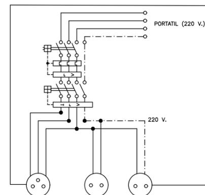
Cuadro con protección frente a cortocircuitos y corrientes de defecto. Se instalará en las plantas o zonas en donde se precise su utilización.
