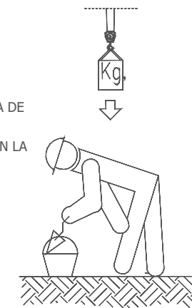
GRÚAS TORRE (PRECAUCIONES A TENER EN CUENTA EN ESLINGAS Y TRABAJADORES).
