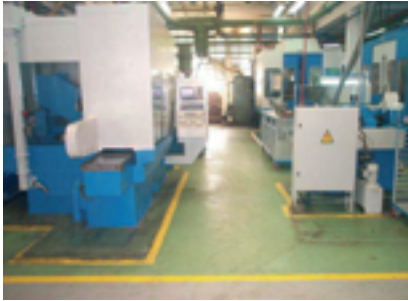
Neco – Identificación general. Se pintan en el suelo “sombras” de equipos y zonas de paso.
