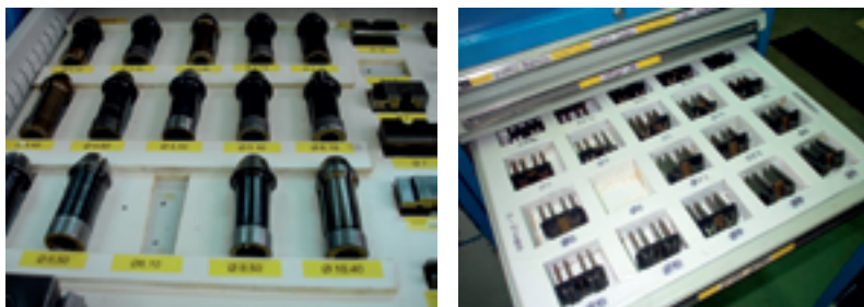
NECO – señalar anomalías. Huella que indica que falta un elemento.
