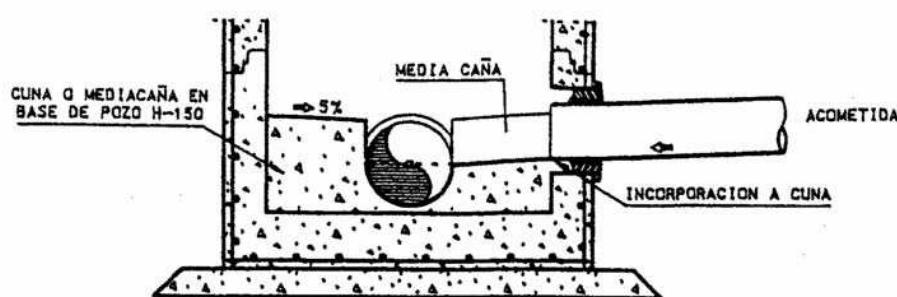
Euri uren sareetan, kolektoreak zein harguneak (estolda zuloenak edo zorrotzenenak) putzuarekin lotu ahal izango dira, irteera kolektorearen malda hidraulikoaren gainetik; gehienez ere 1,60 m-ko altueratik.
