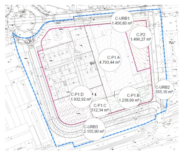
Se han dividido las distintas zonas tanto de la parcela interior (dividida en P1 y P2) como de la urbanización, en función de los puntos a los que se va a derivar el agua caída en el ámbito. Existen 3 puntos de conexión de las aguas del ámbito:
